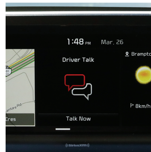
La fonction du partage de la conversation du conducteur rediffuse, d'une simple pression d'un bouton, la voix du conducteur dans les haut-parleurs arrière, pour se faire entendre facilement des passagers assis aux 2 e et 3 e rangées.
