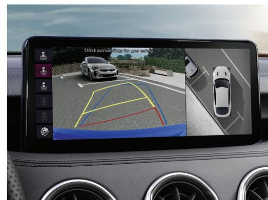
**Le système de surveillance<sup>1,2</sup> par caméras à 360°** utilise des caméras pour vous fournir, en temps réel, une vue de dessus de votre véhicule, afin de simplifier vos manœuvres de stationnement.
