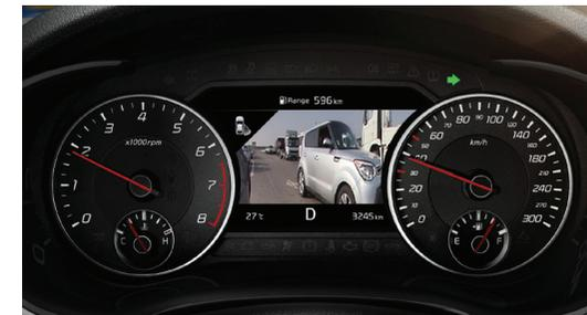
**L'écran de surveillance des angles morts<sup>1</sup>** s'allume automatiquement au tableau de bord lorsque vous mettez le clignotant. L'angle mort correspondant au côté du clignotant s'affiche alors.
