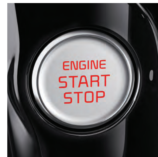
La clé intelligente et le démarrage à bouton-poussoir 1 vous permettent de démarrer votre véhicule en gardant la clé dans votre poche.
