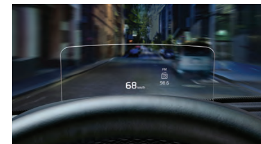
L'affichage tête haute (HUD) 1 projette subtilement les informations de conduite sur un écran secondaire au-dessus du volant.
