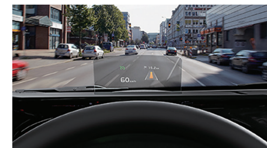
L'affichage tête haute (HUD) 1 projette subtilement les informations de conduite importantes sur un écran secondaire placé au-dessus du volant.
